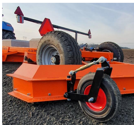
Enkel nivåreglering av strängspridarhjul
